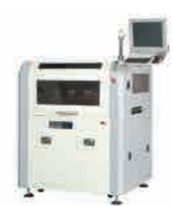
蛍光塗布装置
