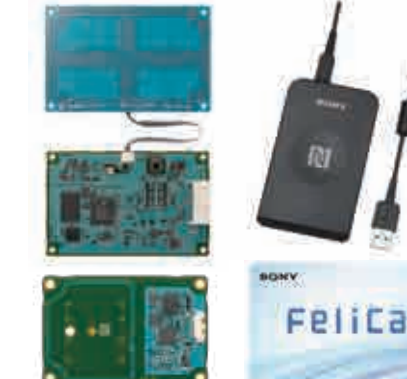
非接触ICカードシステム
