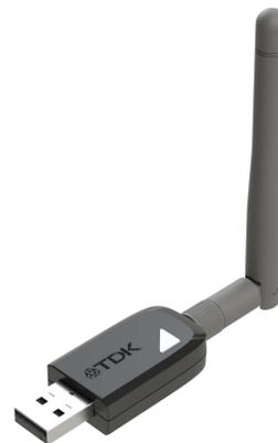
Network Controller は i3 CbM Solution 専用のワイヤレスゲートウェイです。
