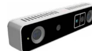
高精度自己位置と姿勢推定技術とエッジAI処理機能を搭載、カラーカメラ、ToF奥行きカメラ、3Dステレオカメラそして高速IMUセンサを内蔵するロボットビジョンカメラ
