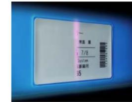
専用のレーザーマーカとラベルにより、通箱のラベル表示を非接触で繰り返し約1000回書き換え可能
