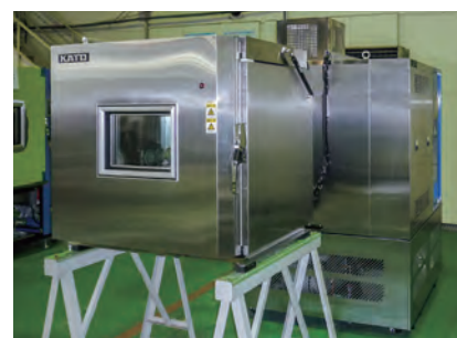
冷熱風発生装置
