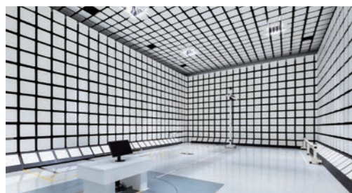
10m法電波暗室
