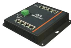
DIN レール取り付け、壁掛け取り付けに加え、マグネット取り付けにも対応。様々な場所に取り付けることができます。極限まで奥行きを薄くしたデザインで省スペース化に貢献します。
