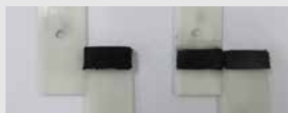
処理無し プラズマ処理 接着剤層 / 基材間での界面破壊 接着剤層の凝集破壊
