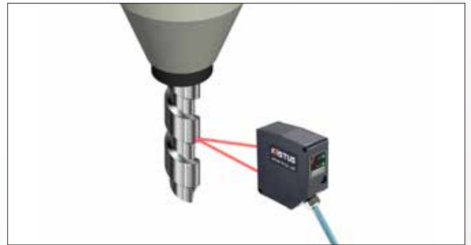
大径ドリルのフレ量測定
