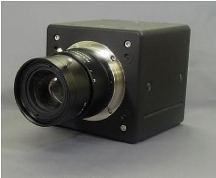
専用設計のビームスプリッターを使用し、各波長帯域をカバーするラインセンサーを各々1個使用したラインスキャンカメラで、400nmから1900nmの広い波長帯に感度を持たせています。
