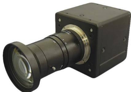
専用設計のビームスプリッターが光を P 波と S 波に分離し、各々を 4K ラインセンサーが受光するラインスキャンカメラで、P 波と S 波の映像を同時に出力することができます。表裏面のガラスの傷を 1 台のカメラで同時に検出するなど厚みを持った透明物体の検査、電子部品の基板実装検査、原材料の異物検査などに使用できます。
