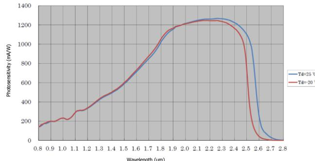
BV-C2906 は 900nm から 2550nm に感度を持つペルチエ素子内蔵の InGaAs センサーを使用した短波長赤外専用のラインスキャンカメラです。受光感度が 2550nm まで伸びておりますのでさらに広範囲の異物等の検出に有効です。インターフェースはギガビットイーサネット、レンズマウントはCマウントです。
