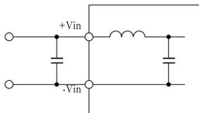
入力電源からPV、PVDシリーズまでの距離が長い場合は、入力ラインのインピーダンスが高い状態にあり、スパイクノイズや配線のインダクタンスが機器に悪影響を及ぼす場合があります。この様な場合には、外付けコンデンサを接続することを推奨致します。外付けコンデンサ容量は、0~220μF程度です。ご使用条件により最適なものを選択して接続して下さい。
