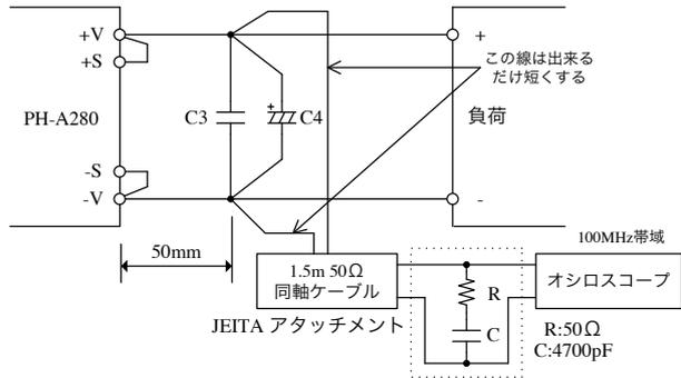
図6-7 出力リップル電圧 (含スパイクノイズ) 測定方法
