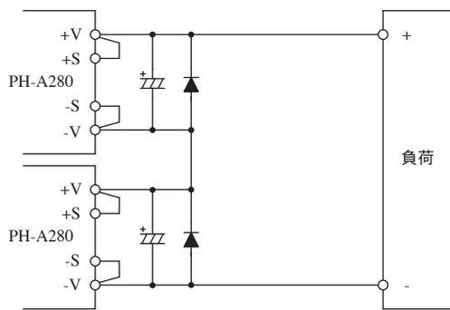
図6-14 出力電圧積み重ね直列運転
