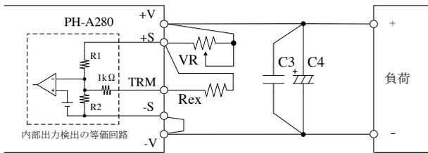
図6-6 外付け抵抗の接続例(3)
