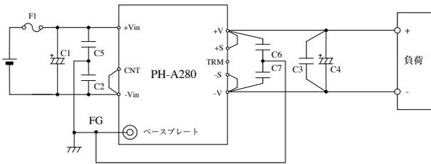
図6-21 外付け部品接続例
