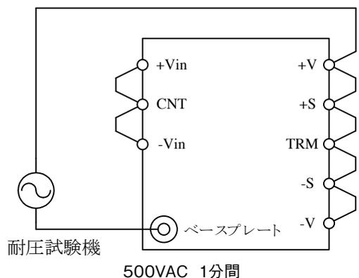
図6-20 出力・ベースプレート間耐電圧試験方法
