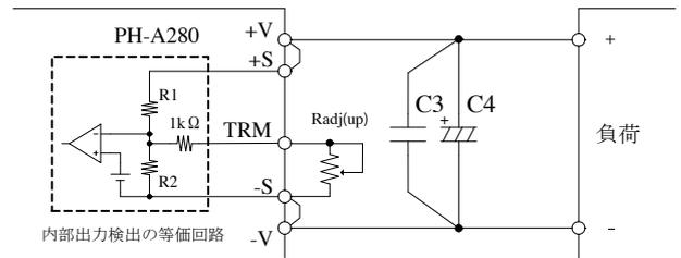
図6-4 可変抵抗接続(2)
