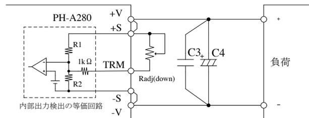
図6-2 可変抵抗接続(1)
