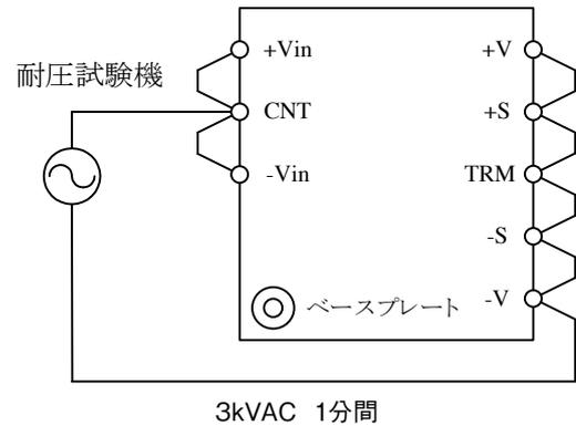
図6-18 入力・出力間耐電圧試験方法
