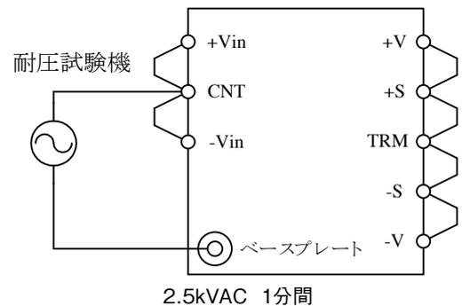
図6-19 入力・ベースプレート間耐電圧試験方法
