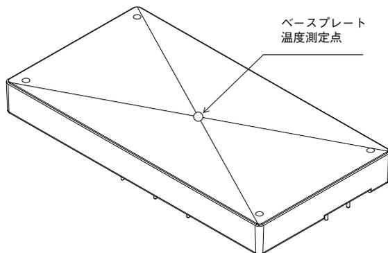
図 5-1 ベースプレート温度測定点
