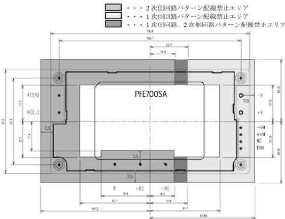
図 5-5 電源実装基板パターン配線禁止エリア
