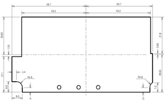
図 5-6 電源カバー外形寸法図
