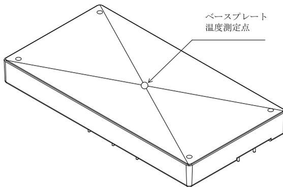
図 5-1 ベースプレート温度測定点
