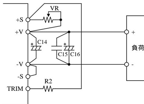
図 4-1 外付け抵抗の接続例
