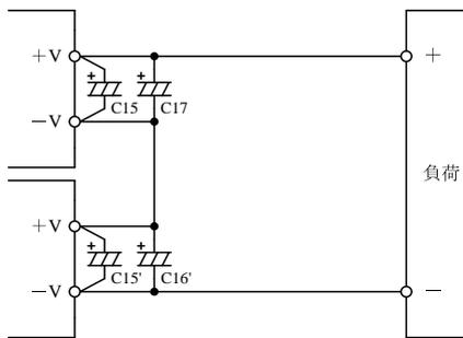
図 4-2 出力電圧積み重ね直列運転
