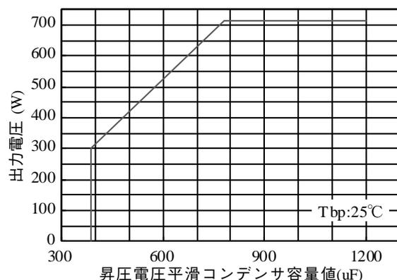
図 3-3 出力電力 対 昇圧電圧平滑コンデンサ容量値
