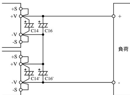
図 4-5 出力電圧積み重ね直列運転
