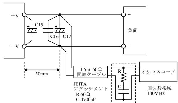
図 4-1 出力リップル電圧 (スパイクノイズ含む) 測定方法
