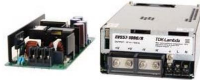
EVSシリーズは簡易定電流定電圧電源です。各種蓄電池の充電用途や水の電気分解など、定電流定電圧制御が求められる用途に特化した製品です。300Wモデルはファンレスを実現しました。くわえて、電源と蓄電池間に挿入される、ダイオードに比べて発熱の少ない、逆流防止モジュール(EVS-RP)を開発しました。
