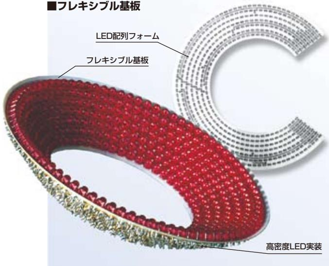
フレキシブル基板を用いることにより、目的に応じて外径や内径、照射角度等を設定し、ワークの撮像に最適な照明を製作することが可能になりました。
