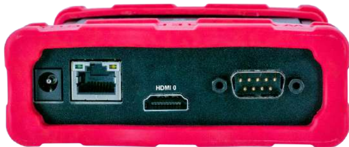
USB ポートから給電する RAD-Moon デバイスで車載イーサネット化
