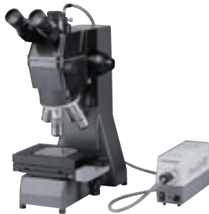
写真：FS70Z及びXYステージ装着例 (接眼レンズ・対物レンズ・レボルバ・照明装置はオプションです)
