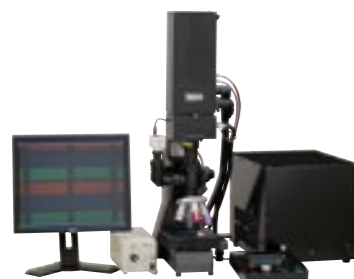
VMU-L4BによるUVレーザ加工 (写真提供: ㈱イ・テクノロジー)
