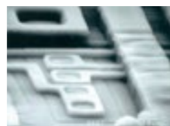
上層レイヤーの撤去後のIC表面SEM写真
