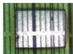
ポリイミド膜の剥離
