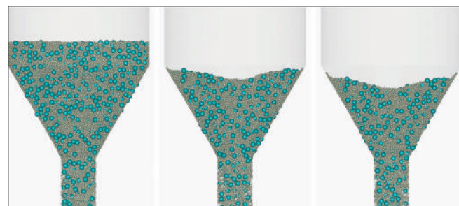
ホッパー内の粉末排出フロー 排出率 10 vol% (左), 50 vol% (中央), 70 vol% (右)
