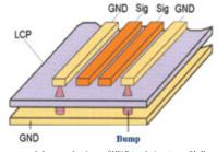
マイクロストリップ構造により GND 強化 GND strengthened by microstrip structure
