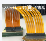
耐ノイズFPCケーブル ベータ 配線面 GND面
