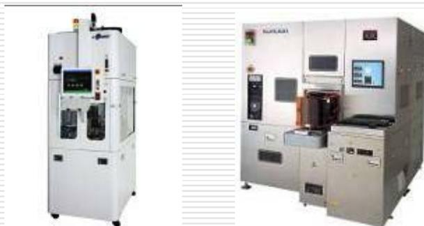
● 縦型外周ノッチ端面研磨機、
