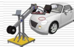
塗装色検査装置 (測定イメージ)
