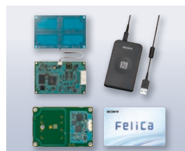
▲ 非接触ICカードシステム
