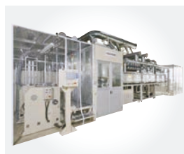
▲ 電極塗工乾燥炉
