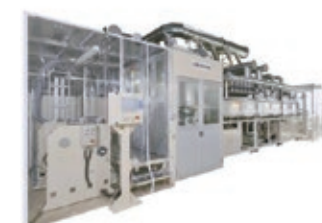
電極塗工乾燥炉
